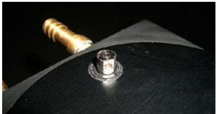
Abb. 3 Einbringen eines Strahlerstiftes in die Nebelkammer
