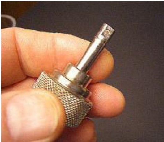
Abb. 3 Einbringen eines Strahlerstiftes in die Nebelkammer
