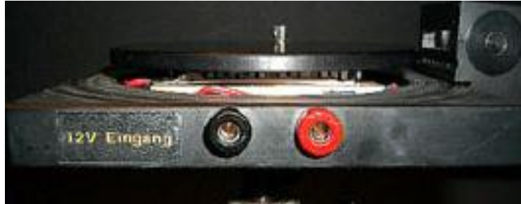
Abb. 5 Anschlüsse für die Versorgungsspannung von 12-15V / 8A
