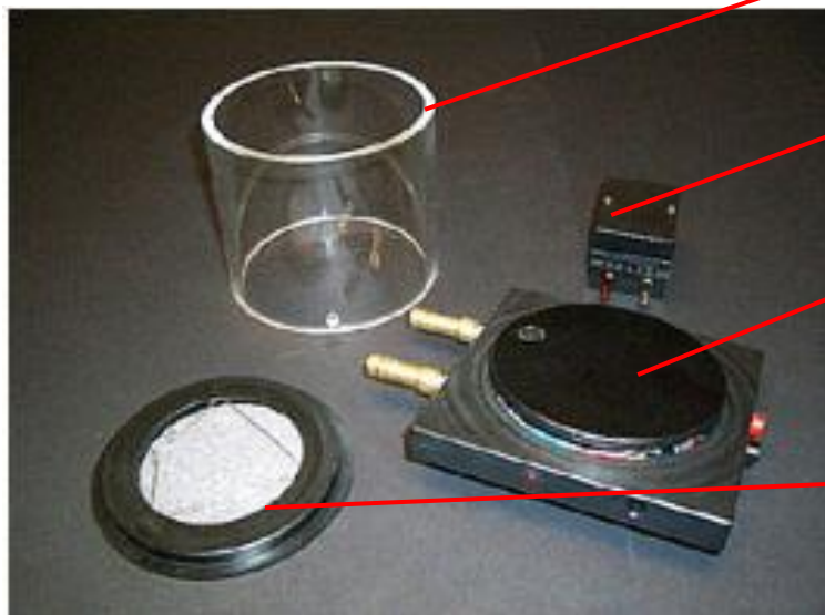
Abb. 1 Komponenten der Nebelkammer
