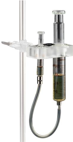
Dieses Modell veranschaulicht die Funktionsweise der Hydraulik. Hebel: Wenn die Kolben heruntergedrückt werden, wird eine kleinere Kraft auf den kleinen Kolben wird eine große Kraft ausgeglichen. auf dem großen Kolben.
