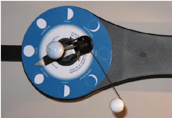
2: Orbit™-Tellurium mit kleinem Erdglobus um die Mondphasen und -finsternisse zu zeigen.
