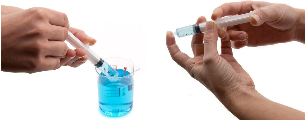
Du wirst feststellen, dass sich der Kolben nicht bewegt, unabhängig davon, wie stark du auf den Kolben drückst. Es zeigt sich, Wasser (und andere Flüssigkeiten) sind nicht elastisch. Entleere die Spritze nach dem Versuch.
