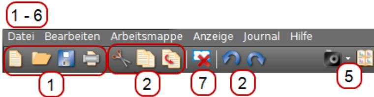
Das Capstone-Menü enthält häufig verwendete Anwendungsfunktionen und anwendungsspezifische Funktionen. Eine Funktionen stehen als Symbolleisten-Schaltflächen zur Verfügung.
