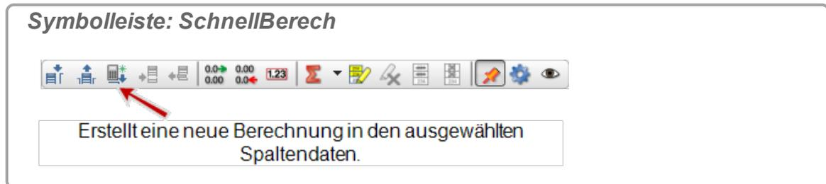
↻ Eine neue Tabellenspalte mit einer Standardberechnung wird hinzugefügt, die die ausgewählte Messung enthält.
