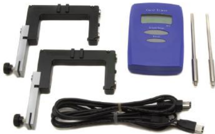
Stoper z 2 widelkowymi czujnikami fotoelektrycznymi
